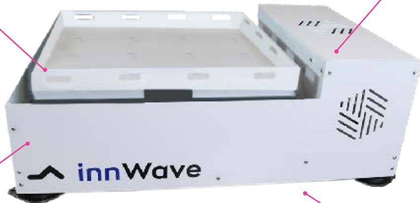
Masa sísmica de acero + amortiguadores para el aislamiento
