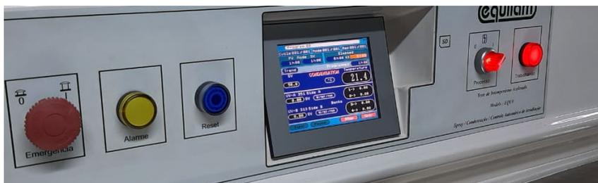
otimização de custos nas despesas com lâmpadas, toda a tecnologia fornecida diretamente em uma Tela Touch Screen, com software amigável EQUV CONTROL. Dependendo da Intensidade de irradiação selecionada podemos até triplicar a vida útil do conjunto de lâmpadas durante o ensaio.
