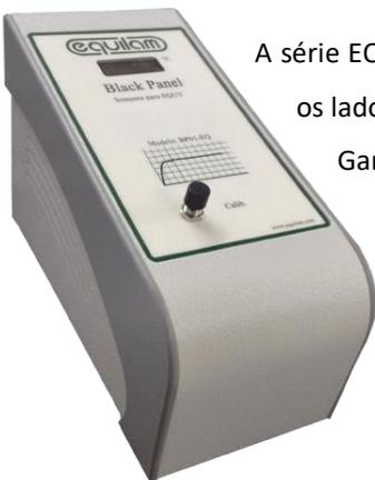
A série EQUV proporciona, sistema para validação da temperatura do BLACK PANEL da câmara em ambos os lados, permitindo por meio da comunicação entre o BP CAL (Calibrado ISO 17025) e os BP da câmara. Garantindo a homogeneidade de temperatura nos modos UV e Condensação em ambos os lados da câmara. Outra vantagem é a facilidade de calibração – verificação da temperatura dos BP sem deslocamento da câmara.
