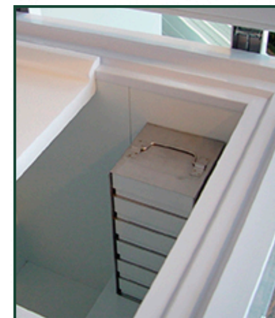
Tampas internas (lado esquerdo) que são obrigatórias para o funcionamento otimizado
