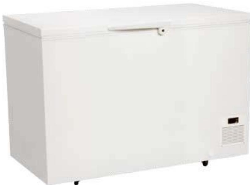
No equipamento EQF-BT a temperatura é mantida a um nível constante e pode ser facilmente monitorada pelo display digital. A configuração e programação também são feitas com o controlador, que, além disso, oferece a possibilidade de adicionar um alarme externo. O isolamento de 100mm de espuma de poliuretano garante que a temperatura subirá muito lentamente em caso de falta de energia.
